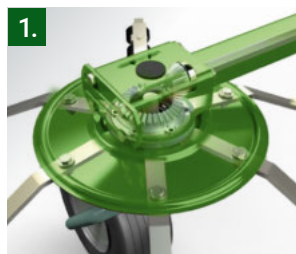
1. Inductiegeharde en geslepen tandflanken zorgen voor een soepele loop en hoge breukbestendigheid
