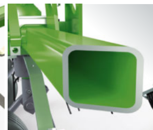
De solide frameconstructie van vierkante buizen zorgt voor een hoge stabiliteit bij een gering eigen gewicht
