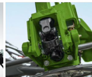
Stabiele aandrijflijn bestaande uit zeskantige as en dubbele kruiskoppeling
