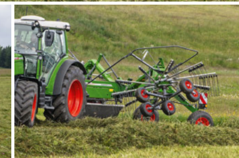
Het zwaddoek klappt in de kopakker- of de transportstand automatisch naar boven.
