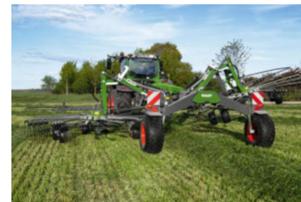
Schoon harkwerk op oncourante percelen en aan de randen van het veld door afzonderlijk uitheffen
