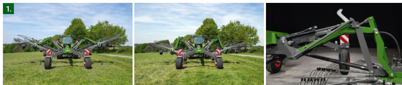
Zwad-/werkbreedteverstelling standaard hydraulisch en via ISOBUS op PRO-modellen
