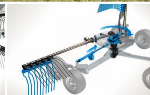
De veranderde stand van de curvebaan resulteert in een beter moment voor het uitheffen van de tanden.
