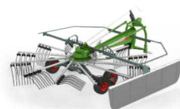
Driepuntsaanbouw, met naloopinrichting Veelzijdig en simpel in het gebruik Werkbreedtes van 3,40 – 4,50 m
