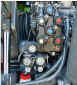
De hydrauliekaansluitingen zijn voorzien van kleurkenmerken. Daardoor zijn werktuigen snel en veilig aan te koppelen.
