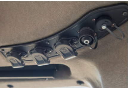
Stroomaansluitingen voor externe verbruikers zijn netjes maar goed toegankelijk tegen het dak aangebracht.
