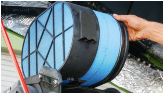
Het luchtfilter is gemakkelijk te vervangen en is voorzien van een vuilsensor die informatie geeft over de filterwerking.
