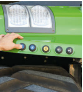
Achterhef, aftakas en een hydrauliekventiel bedient u gemakkelijk vanaf de achterspatborden.
