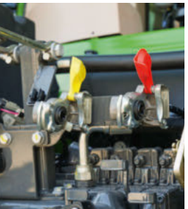
Als de parkeerrem is ingeschakeld, werkt de luchtdrukrem met dubbel circuit ook op de aanhanger.
