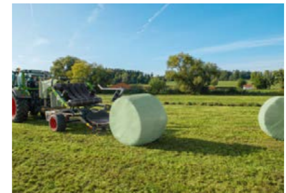
Dankzij de aflegtafel met actief baalaflegstelsysteem van de Rollector 160 wordt elke baal voorzichtig neergelegd en wordt beschadiging van de folie voorkomen.
