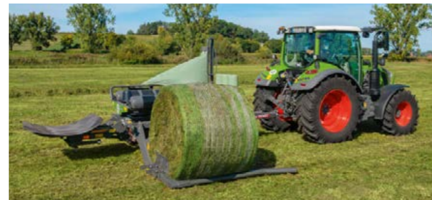
Zowel de laadarm als de wikkeltafel kunnen aan verschillende baalafmetingen worden aangepast. Balen met een diameter van 1,25 tot 1,60 meter kunnen veilig worden opgepakt en luchtdicht in folie worden verpakt.
