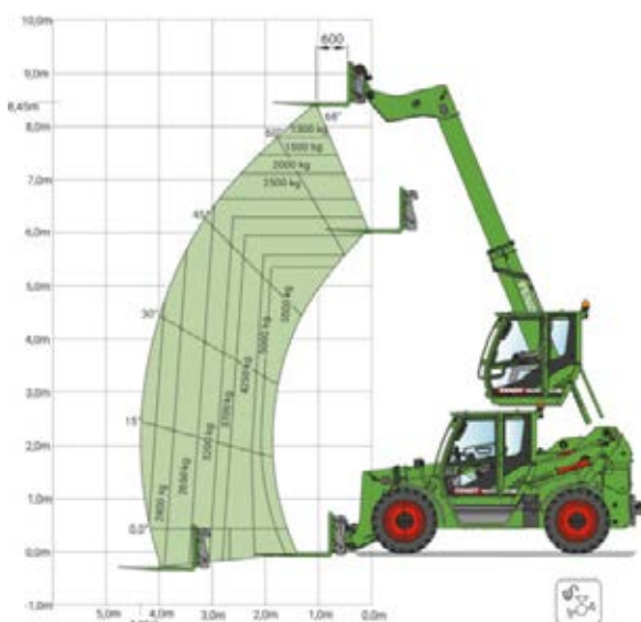
Draagvermogen en bereik zonder hydraulische niveauecompensatie / zonder pendelasblokkering Met een palletvork
