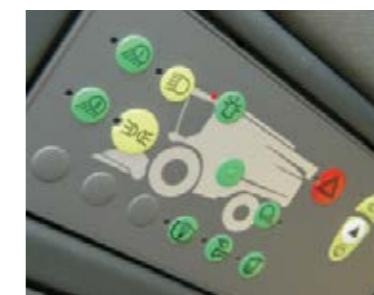
Klar oversikt over aktiverte arbeidslys i det lyse betjeningspanelet.
