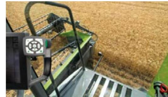
Utmerket oversikt til tömmesektoren for rask tömming av korntanken med opptil 105 l/sek.
