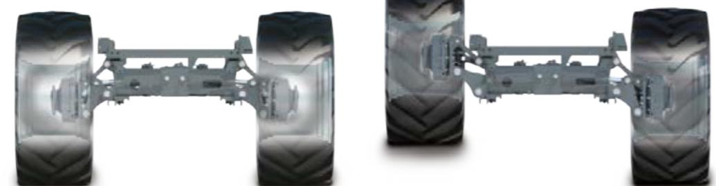
Enkelt å skifte mellom arbeids- og transportmodus med ParaLevel-systemet, som kompenserer for hellinger på inntil 20 %.
