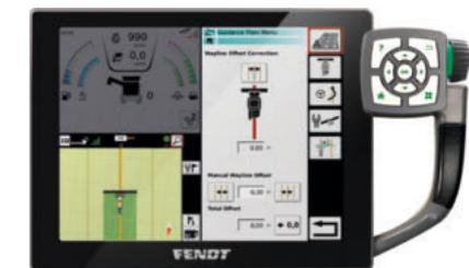
Innstillingerne for VarioGuide automatiske sporfølgingssystem kan enkelt justeres i Varioterminalen.
