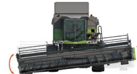
AutoLevel skjærebordsstyring er standard og sikrer konstant stubbhøyde over hele skjærebordsbredden.
