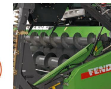
Oljevekstskruen (tilleggsutstyr) øker avlingsstrømmen bakover til loelevatoren i lang avling og bidrar til økt kapasitet.
