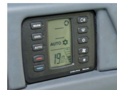
Det avanserte klimaanlegget kontrollerer temperaturen automatisk for et godt arbeidsmiljø.
