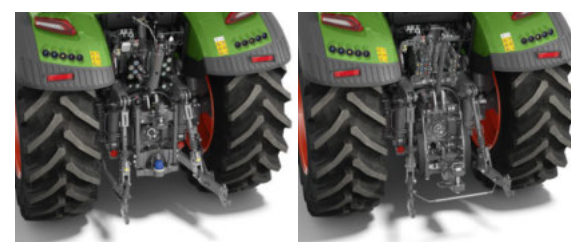
Trepunktshydraulikk bak med fanghaker og stabilisatorstag (EU)
