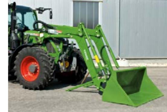
Fendt Cargo-Lock garanterer rask og enkel til- og frakobling. Med multikoblingen er det enkelt å koble alle hydraulikkslanger og el-kabler samtidig, selv med trykk på frontlastersiden.
