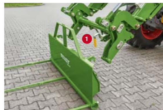
Du kan enkelt låse opp redskapet med en spak (1) på hurtigkoblingsfestet, alt som trengs, er en enkel håndbevegelse. Når du monterer et redskap, låses det automatisk ved å tilte det helt tilbake.
