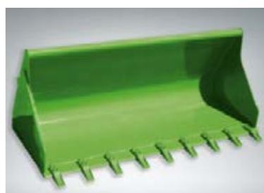
Tungmaterials kuffen leveres med bredder på 1600 mm (0,53 m<sup>3</sup> strøket volum) og 2000 mm (0,67 m<sup>3</sup> strøket volum). Skuffebunnen er avrundet og glatt for å unngå at materialet blir sittende fast. Slitestålet er lavet av herdet, slitasjebestandig høykarbonstål og er 150 x 20 mm. De inkluderer også industrielle lastertrenner som er boltet i flukt på undersiden av slitestålet, og hindrer dermed spor ved planering.
