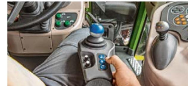
På vendeteiger eller ved frontlasterarbeid, nyter du godt av VarioActive styring, hvor du oppnår full sving på hjulene med kun én omdreining på rattet. Opp til 8 km/h er utvekslingen på styresystemet maksimal, fra 8 til 18km/h er styreutvekslingen lineær.
