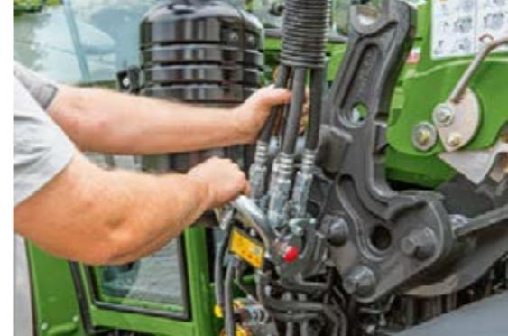
Med nyheten Fendt Cargo-Lock er nå til- og frakobling av Cargo-lasteren blitt mye lettere og raskere. Multikoblingen sparer også tid. Det betyr at du kan koble til alle elektriske kabler og hydraulikkslanger med en enkelt håndbevegelse.
