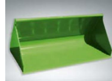
Lettmaterialskuffen leveres med bredder på 2100 mm (1,27 m<sup>3</sup> strøket volum) og 2400 mm (1,45 m<sup>3</sup> strøket volum). Skuffen er pulverlakkert i stedet for lakkert, og slitestålet er laget av sterkt, slitasjebestandig Hardox 500.
