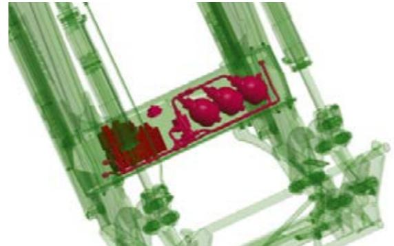
Alle hydraulikkomponenter er montert i tverrøret, og er derfor fullstendig beskyttet mot urenhet og mekanisk skade.
