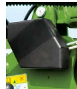
To trykksensorer i tverrorret gir mulighet for veiefunksjon med CargoProfi.
