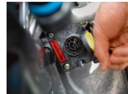
Sensorene for Cargo Profi-funksjonene er plassert på høyre side av frontlasteren, der de er godt beskyttet.
