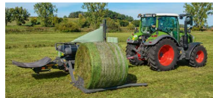
Både lastearmen og pakkebordet kan tilpasses forskjellige ballestørrelser. Sikker opptak av baller med diameter 1,25 m til 1,60 m.
