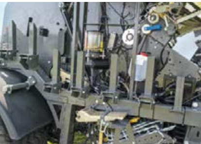
Du går ikke lenger tom for folie når du har 12 folieholdere på pressen. Det er bare å plassere folierullene med innpakking på de individuelt nedfellbare holderne.
