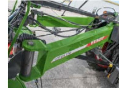
Ved transport blir rotorene foldet hydraulisk og sikret mekanisk.
