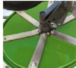
Stor diameter på rotorplatene betyr at tindehastigheten forblir høy ved lav rotorhastighet.
