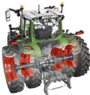
Bakaksel med justerbar sporvidde 2500 mm tvillinghjul med Duo hjulnav
