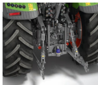
Trepunktshydraulikk bak med fanghaker og sidestabilisatorstag (EU)
