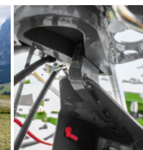
Automatisk løftelås på DN-modellene
