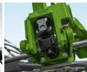
Stabil drivlinje bestående av sekskantaksel og doble kardangledd
