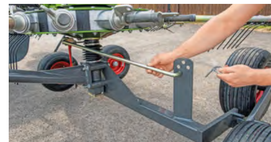
Enten avlingen er lang og tung, kort og lett: Kamsporet kan justeres etter innhøstingsforholdene.
