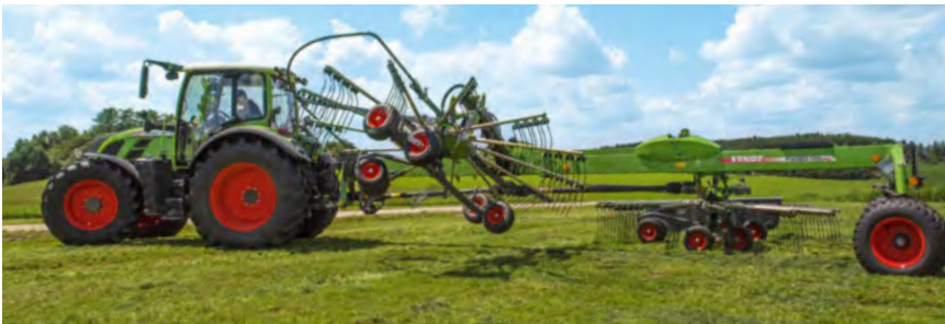
Rekkefølgestyringen løfter alltid rotorene på Fendt Former i riktig rekkefølge.
