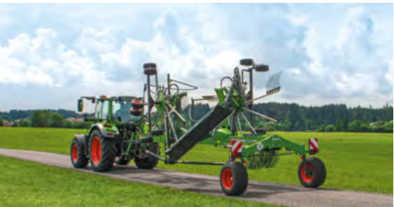
Fendt Former sideavleggende rive med to rotorer foldes sammen til en kompakt enhet og er like brukervennlige langs veien.
