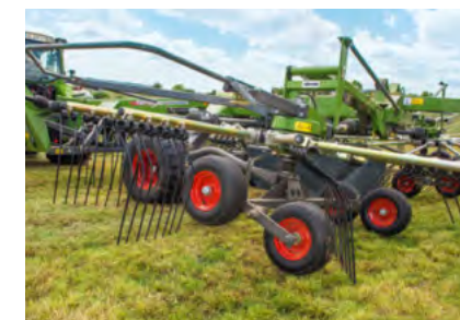
Når riven senkes på vendeteigen settes først bakhjulene på bakken, og deretter forhjulene. Når riven løftes, løftes rotorene først i fremkant. Jet-Effect beskytter grastorva.
