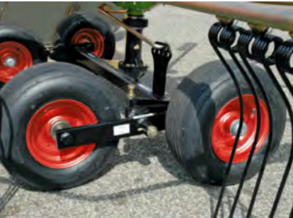
Tandemakslinger og bred sporvidde sørger for stødig gange selv om man kjører fort.
