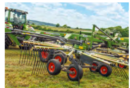
Når riven senkes på vendeteigen settes først bakhjulene på bakken, og deretter forhjulene. Når riven løftes, løftes rotorene først i fremkant. Jet-Effect beskytter grastorva.
