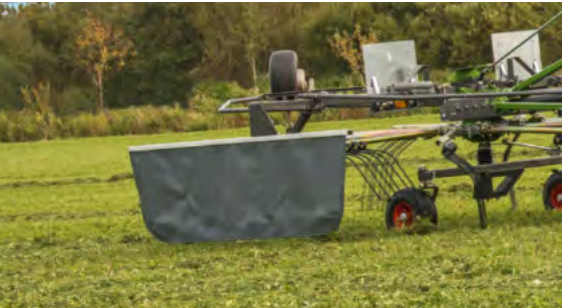
Strengbredden kan justeres raskt og trinnløst ved å flytte den fjærbelastede oppsamlerduken.
