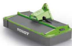
Frontmonterte med pendeloppheeng Spesielt utviklet for bratte fjellskråninger Arbeidsbredde 3,00 m
