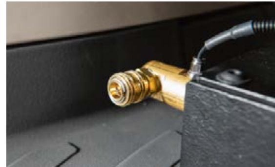
Rengjør førerhuset raskt takket være den praktiske trykkslangekoblingen.
