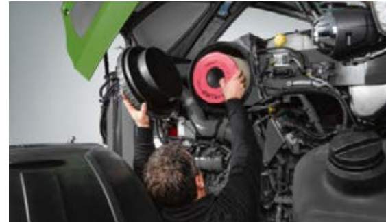
Smussnivået i luftfiltrene vises på Varioterminalen. Motorrommet er svært tilgjengelig med avtakbare sidepaneler.
