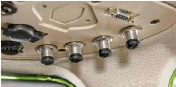
Kameratilkoblinger De 4 kameratilkoblingene (2 digitale og 2 analoge) i taktrekket viser bildet i svært høy oppløsning i terminalen.
