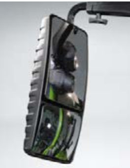
Elektrisk justerbare sidespeil Sidespeilene med separate vidvinkelspeil gir best mulig oversikt og sikkerhet. Du kan enkelt justere dem i terminalen eller med dreietrykkbryteren.
