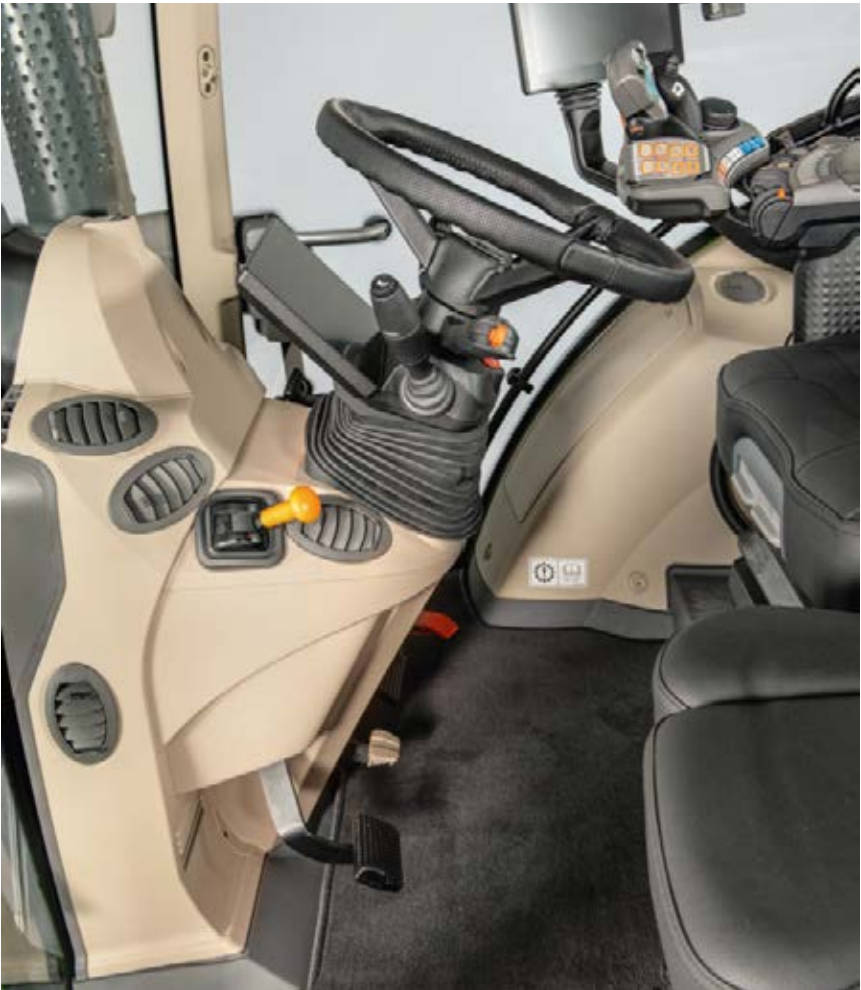
Tiltbar rattstamme med digitalt instrumentpanel Det digitale instrumentpanelet justeres med rattet. Dette betyr at alle førere kan stille inn en høyde og vinkel som passer, slik at ergonomien alltid blir perfekt.
