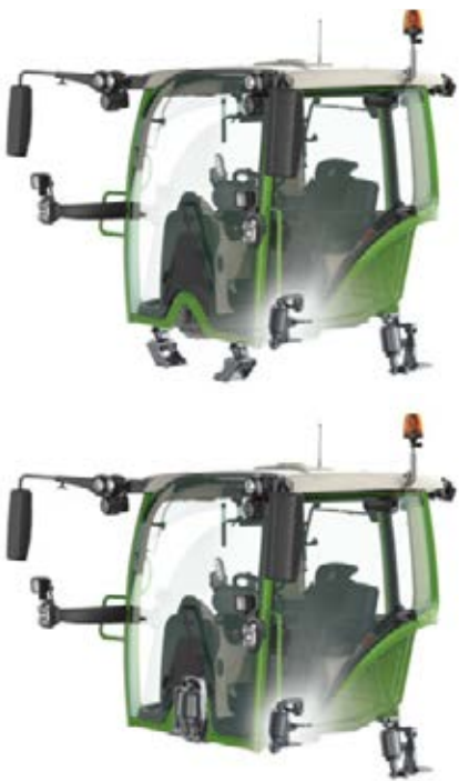
Fjæret førerhusoppheeng – velg mellom 2 utgaver: Pneumatisk: konisk lager foran, luftfjæring bak. Førerhus med 4 lagre, pneumatisk komfort: 3-punkts pneumatisk førerhusfjæring (sentral svingarm foran og 2 trykkluftputer bak)
