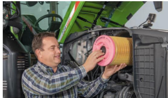
Et panser som kan svinges opp og avtakbare sidepaneler gir utmerket tilgang til motorrommet. Dette betyr at du raskt og enkelt kan fjerne luftfilteret.
