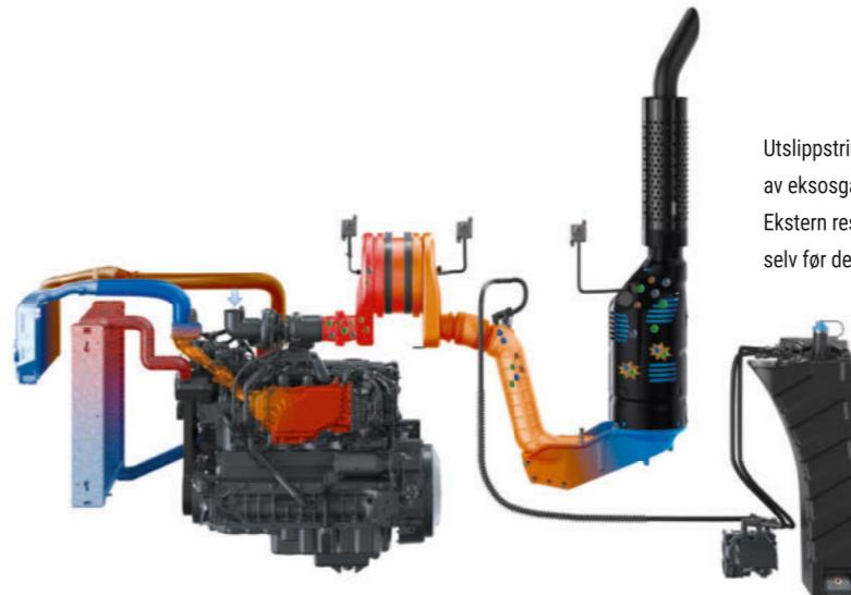
Utslipstrinn V oppfyller takket være ekstern resirkulering av eksosgasser, SCR-teknologi og dieselpartikkelfiltre. Ekstern resirkulering av eksosgasser reduserer nitrogenoksidene ( $\text{NO}_x$ ) selv før de når eksosrøret, slik at det kreves mindre AdBlue.
