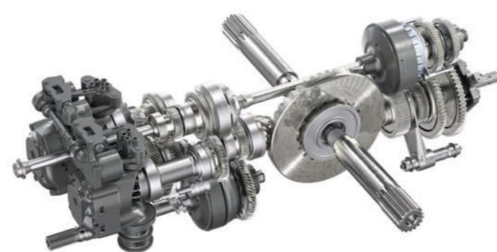
Fendt Vario-transmisjonen er en kombinasjon av hydrostatisk og mekanisk drift. Med økende hastighet øker andelen av mekanisk kraft som overføres gjennom planetgiret. Hydrostatene har en maksimal vinkling på 45 grader. Sammen med et driftstrykk på opptil 550 bar gir dette en eksepsjonell høy effektivitet.
