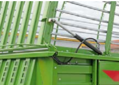
Det nedfellbare overbygget kan foldes opp og ned hydraulisk som tilleggsutstyr.
