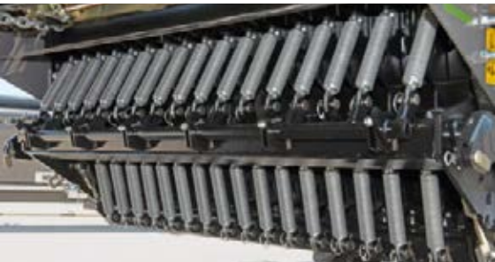
Som tilvalg kan du også velge å hydraulisk kunne svinge knivene mellom arbeidsstilling og serviceposisjon.
