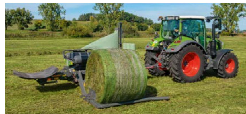
Både lastearmen og pakkebordet kan tilpasses forskjellige ballestørrelser. Sikkert opptak av baller med diameter 1,25 m til 1,60 m.
