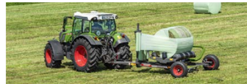
Fendt Rollector pakker baller med diameter fra 0,90 m opp til 1,30 m.
