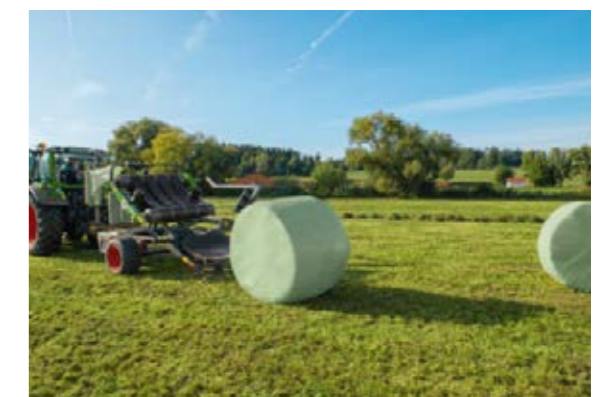
Rollector 160 er utstyrt med balleavlastningsbord med aktiv avlasting, noe som hindrer at filmen skades.
