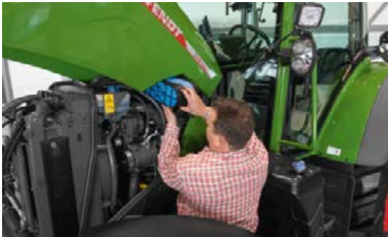
Det effektive luftfilteret oppnår maksimalt luftinntak og rengjøring og kan lett skiftes ut.
