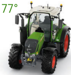
Panoramafrontvindu med 77° sikt oppover og fram mot forhjulene.
