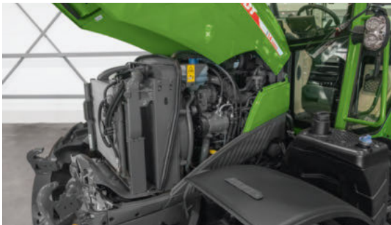
Motorrommet er veldig enkelt tilgjengelig for inspeksjon og vedlikehold, selv med frontlaster tilkoblet. Panseret har to separate sidedeler slik at det er lett å åpne det.
