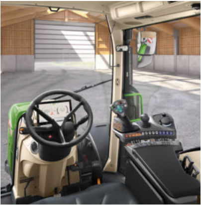
Profi Setting 1 - Krysspak - 1 lineær modul (par med fingertuppebrytere) for å betjene hydraulikkventilene
