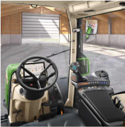
Power Setting 1 - Ingen krysspak - 1 lineær modul (par med fingertuppebrytere) for å betjene hydraulikkventilene
