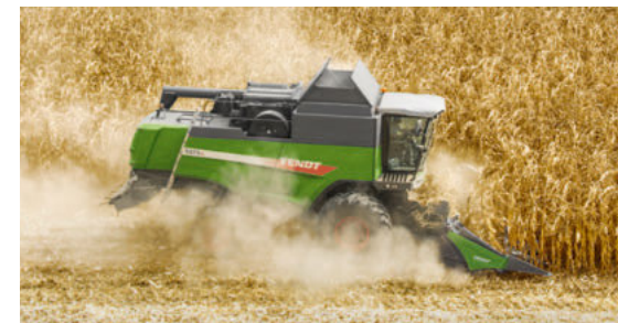
Foruten utsiftbar seksjonsbro, leveres også et maisutstyr for høsting av mais.
