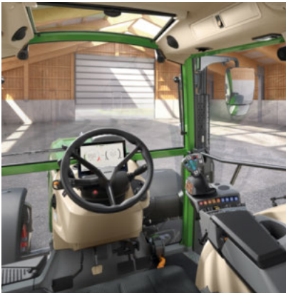
Power Setting 1 - Ingen krysspak - 2 lineære moduler (fingertuppbrytere) for å betjene hydraulikkventiler
