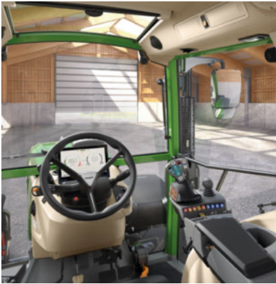
Power Setting 2 - Krysspak - Ingen lineær modul (fingertuppbrytere)
