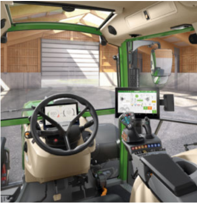
Profi Setting 2 - 3L krysspak - 2 lineære moduler (fingertuppbrytere) for å betjene hydraulikkventiler - 12" terminal
