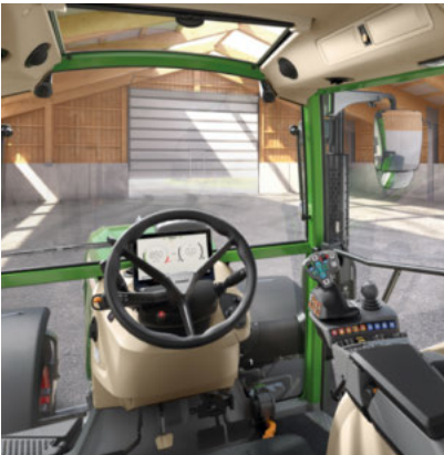
Profi Setting 1 - Krysspak - 2 lineære moduler (fingertuppbrytere) for å betjene hydraulikkventiler
