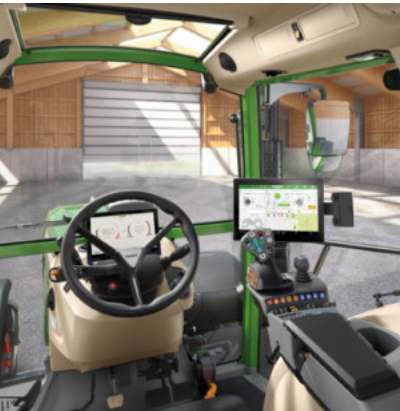
Profi+ Setting 1 - Krysspak - 2 lineære moduler (fingertuppbrytere) for å betjene hydraulikkventiler - 12" terminal
