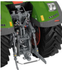
Trepunktshydraulikk bak med kuleender og stabilisatorblokker
