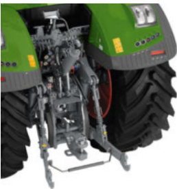
Trepunktshydraulikk bak med fanghaker og stabilisatorblokker (unntatt EU)
