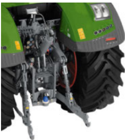
Trepunktshydraulikk bak med fanghaker og sidestabilisatorstag (EU)
