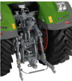
Trepunktshydraulikk bak med fanghaker og stabilisatorblokker (unntatt EU)
