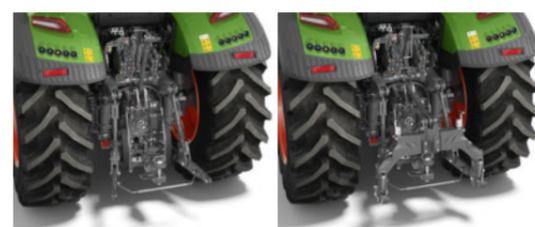
Trepunktshydraulikk bak med kuleender og stabilisatorblokker
