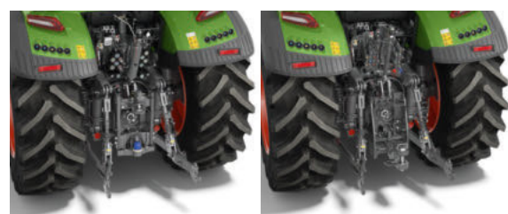
Trepunktshydraulikk bak med fanghaker og stabilisatorstag (EU)
