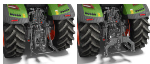
Trepunktshydraulikk bak med kuleender og stabilisatorblokker
