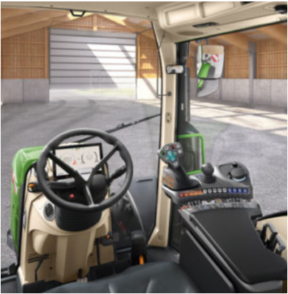
Profi Setting 1 - Dźwignia krzyżowa - 1 moduł liniowy (przełącznik kołyskowy) do sterowania zaworami hydraulicznymi - 12-calowy terminal
