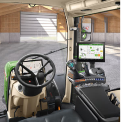
Profi+ Setting 2 - Joystick 3L - 1 moduł liniowy (przełącznik kołyskowy) do sterowania zaworami hydraulicznymi - 12-calowy terminal
