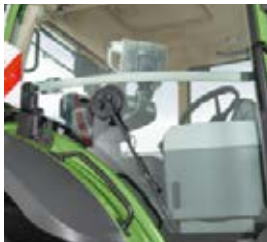
Wycieraczka bocznego okna o zakresie 220° zapewnia dobrą widoczność na prawą stronę nawet w trudnych warunkach pogodowych.
