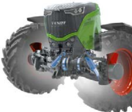
Oś przednia z niezależną, samopoziomującą amortyzacją i hamulcem pojedynczym kół.
