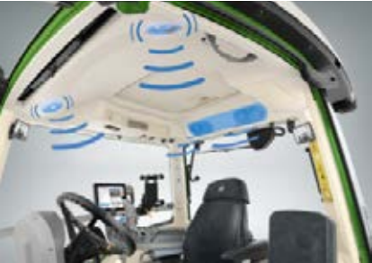
Nowy zestaw informacyjno-rozrywkowy z zaawansowanym systemem nagłośnienia 4.1 zapewnia doskonałą jakość dźwięku dzięki 4 wysokiej klasy głośnikom i subwooferowi.
