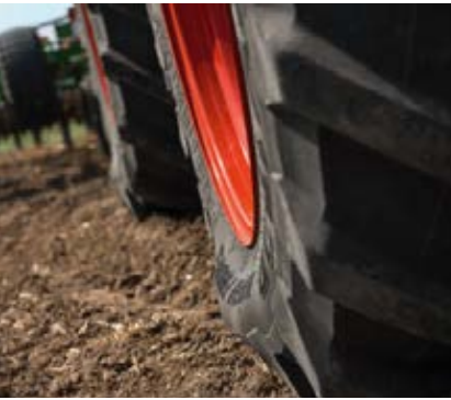
Doskonale zintegrowany układ regulacji ciśnienia w oponach VarioGrip dostosowuje ciśnienie w przedziale od 0,6 do 2,5 bara w ciągu kilku minut. Optymalne ciśnienie w oponach pozwala oszczędzać paliwo, chroni glebę i zwiększa trakcję.
