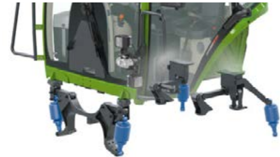
4-punktowe, pneumatyczne zawieszenie kabiny ze zintegrowanym mechanizmem poziomowania ogranicza vibracje do minimum.
