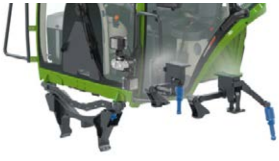
Mechaniczne zawieszenie kabiny opiera się na dwóch łożyskach stożkowych z przodu i dwóch amortyzatorach sprężynowych z tyłu.
