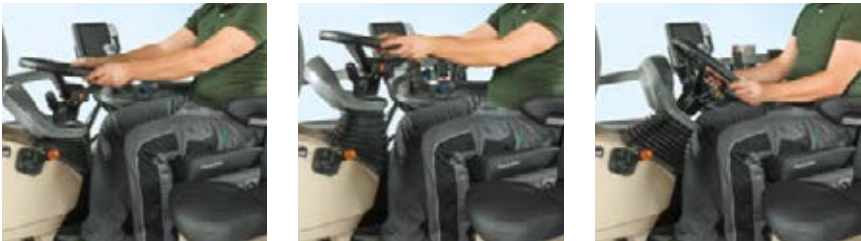
Dla większej wygody kokpit odchyła się równolegle z kierownicą. Kierownicę można łatwo regulować za pomocą pedału, dzięki czemu ręce mogą zająć się czymś innym.
