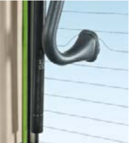
Ogrzewanie przedniej i tylnej szyby znacznie ułatwia pracę z odwróconym stanowiskiem pracy.
