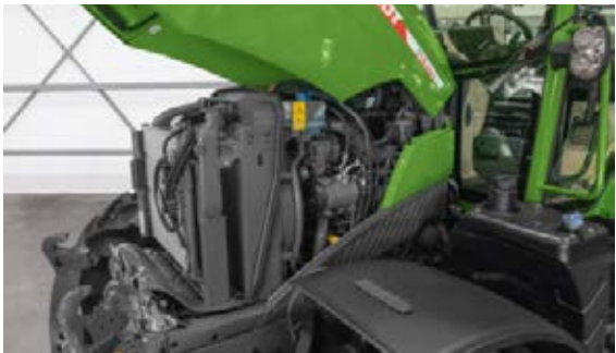
Komora silnika jest bardzo łatwo dostępna w celu przeprowadzenia kontroli wzrokowej i konserwacji, nawet przy podłączonym ładowaczu czołowym. Maskę ma dwie oddzielne części boczne, co ułatwia jej otwieranie.
