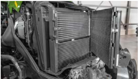
Odciążenie operatora: Kompaktowy pakiet chłodnic jest wyjątkowo łatwo dostępny i można go łatwo i szybko wyczyścić dzięki dużemu prześwitowi pomiędzy chłodnicami a płaskim dnem chłodnicy.
