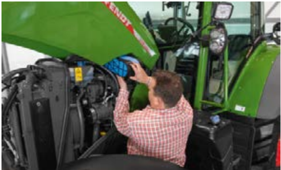
Wysoko wydajny filtr powietrza umożliwia optymalny pobór powietrza i czyszczenie, ponadto można go z łatwością wymienić.
