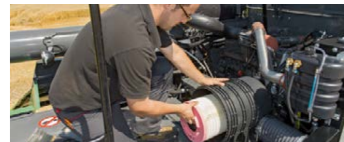
Czyszczenie filtra powietrza
