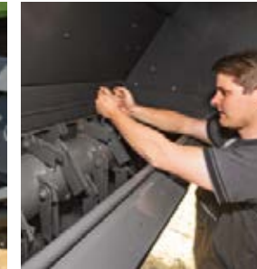
Dostęp do siekacza w celu konserwacji
