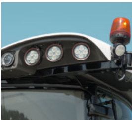
3 pary świateł roboczych na dachu, światła jazdy z przodu dachu, światła boczne i obrotowa lampa ostrzegawcza.
