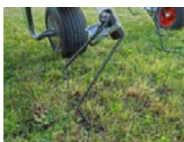
Materiał jest podnoszony za pomocą umieszczonego na palcach Fendt Performance haka o długości 7,5 cm.
