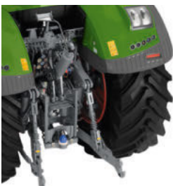
Tylny podnośnik z hakami zaczepowymi i stabilizatorami
