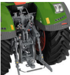
Podnośnik tylny z przegubami kulistymi i blokami redukującymi luz
