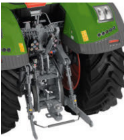
Podnośnik tylny z przegubami kulistymi i blokami redukującymi luz
