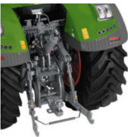
Tylny podnośnik z hakami zaczepowymi i blokami redukującymi luz (na rynek australijski)
