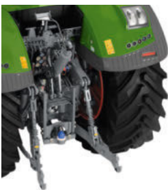
Tylny podnośnik z hakami zaczepowymi i stabilizatorami
