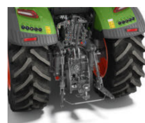
Podnośnik tylny z końcówkami kulowymi i Rub Blocks
