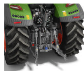
Podnośnik tylny z hakiem zaczepowym i wspornikiem bocznym (UE)
