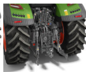
Podnośnik tylny z hakiem zaczepowym i Rub Blocks (AU, RPA, Europa Wschodnia)
