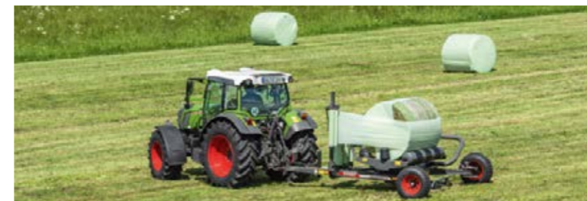
Fendt Rollector способен обматывать рулоны диаметром от 0,90 м до 1,30 м.
