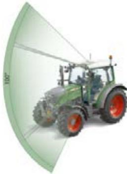
Встроенный люк в крыше обеспечивает прекрасный обзор с впечатляющим углом обзора 100°. Благодаря этому вы будете иметь беспрепятственный вертикальный обзор, от поднятого фронтального погрузчика до колесных арок.
