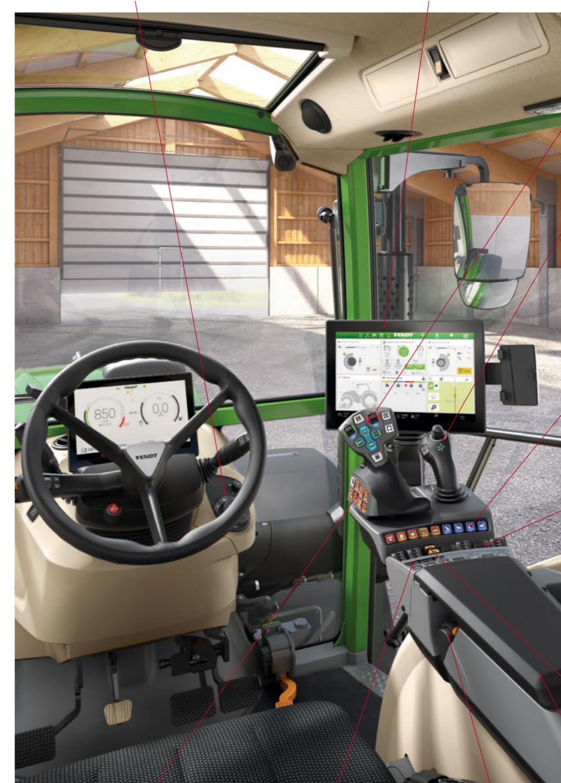
Здесь вы можете легко управлять обычными функциями трансмиссии и вождения с помощью кнопок: включая две программируемых настройки оборотов двигателя, две настройки круиз-контроля и новую настройку активного круиз-контроля с управлением поворотно-нажимной рукояткой.
