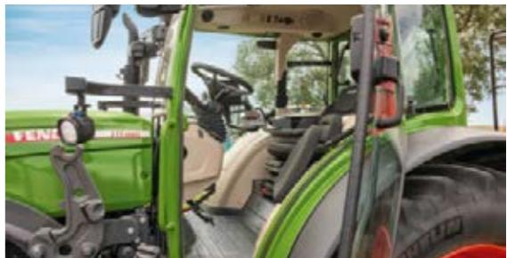
Fendt предлагает оригинальное решение для кабелей, идущих в кабину со стороны задней части трактора. Кабели можно пропустить через специальный ввод, независимо от их сечения. Для предотвращения проникновения в кабину пыли, грязи или воды, а также для снижения уровня шума заднее окно может быть закрыто.
