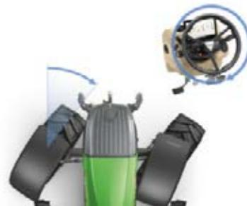
На разворотной полосе или во время фронтальных погрузочных работ вы можете воспользоваться системой рулевого управления FendtActive\*, которая обеспечивает полный поворот колес всего за один оборот руля. До 8 км/ч активная система рулевого управления работает без ограничений, от 8 до 18 км/ч ее эффект работы является линейным.
