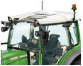
Приемник Fendt Guide превосходно защищен и полностью интегрирован в конструкцию крыши. Это устройство не имеет выступающих частей и проводов с внешним подключением и поэтому всегда хорошо защищено не только от свисающих ветвей, но даже от кражи.
