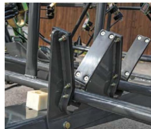
■ Защитные рейлинги Twister, оснащенные долговечными подшипниками, идеально устанавливаются в специальные V-образные кронштейны на раме. (Только на версии с транспортным шасси Fendt Twister).
