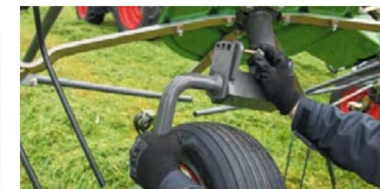
Угол разбрасывания можно быстро и просто отрегулировать между значениями 15, 18 и 21° при помощи регулировочного отверстия на колесах.
