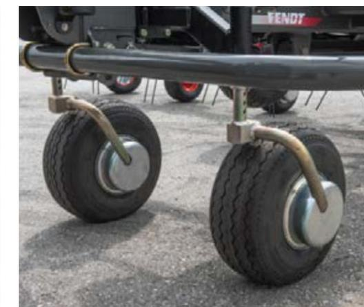
□ Опциональные съемные опорные колеса оптимизируют копирование контуров поверхности и обеспечивают чистое сгребание и защиту стерни. (Fendt Twister 901 T)
