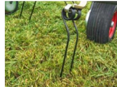
Граблины имеют очень большую площадь контакта в месте крепления к крышке ротора.
