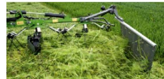
На флагманских моделях Twister 11010 DN разбрасывание по кромке осуществляется при помощи дополнительного гидравлически складывающегося фартука.
