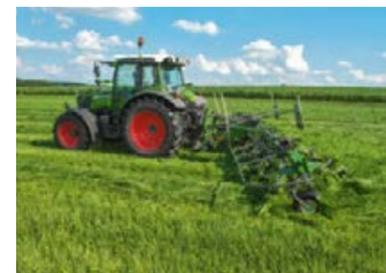
При работе на краях поля можно достигать превосходных результатов благодаря устройству разбрасывания по краям, вокруг которого поворачивается вся ворошилка.
