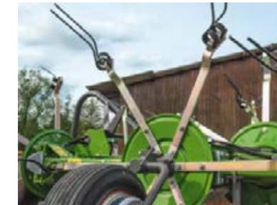
Благодаря закрытой конструкции головки роторов на моделях Fendt Twister надежно защищены от пыли и грязи.
