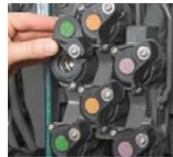
□ Муфты двустороннего действия DCUP (двойное соединение под давлением) значительно ускоряют установку и демонтаж навесного оборудования. Само закрывающиеся заслонки клапанов надежно защищают гидравлическую линию от попадания грязи и воды и позволяют выполнить подсоединение одной рукой.
