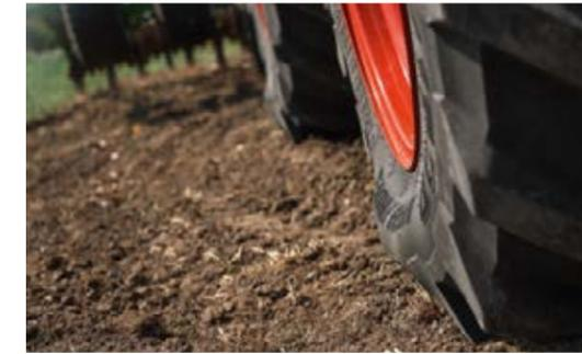
С помощью терминала Varioterminal можно контролировать давление в шинах трактора нажатием всего одной кнопки. Система помощи информирует водителя о слишком низком или слишком высоком давлении в шинах.
