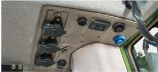
□ В кабине расположено множество розеток, например, несколько розеток 12 В, разъем ISOBUS, сигнальный разъем.
