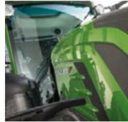
□ Особенностью тракторов Fendt является вклеивание ветрового стекла. Такой способ крепления не только увеличивает поле обзора для оператора; его основной задачей является устранение скрипящих звуков и протечек. Кроме того, оно оснащено подогревом.
