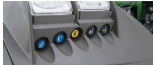
■ С помощью внешних органов управления вы можете привести в действие механизм заднего подъемника, один клапан и вал отбора мощности непосредственно на заднем крыле. При использовании внешних органов управления задним механизмом отбора мощности, предустановленные обороты двигателя могут устанавливаться автоматически. Это позволяет исключить ненужные действия, например при включении всасывания в бак жидких удобрений.
