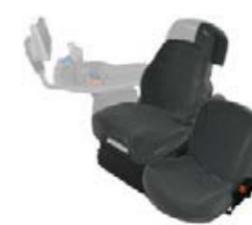
□ Кресло повышенной комфортности Evolution dynamic Dualmotion с пневматической подвеской оснащено спинкой с регулировкой положения, подогревом, низкочастотным амортизатором, пневматической опорой для поясницы и регулируемыми подлокотниками. Чехол для сиденья может быть выполнен из черной ткани или из гладкой черной кожи (в комплект также входит кожаный чехол для рулевого колеса).
