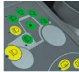
■ Благодаря простой компоновке система освещения легко настраивается и регулируется. Благодаря однокнопочной системе вы можете включить все рабочие фары одновременно всего одним нажатием кнопки на клавиатуре.
