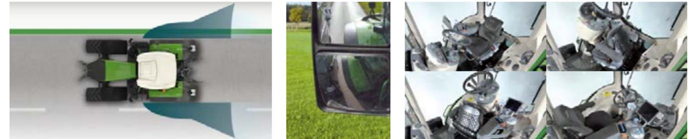
Чтобы еще больше расширить рабочее пространство, Fendt предлагает устанавливаемый на заводе-изготовителе полнофункциональный пост реверсивного управления. Чтобы развернуть на 180 градусов сиденье водителя вместе с рулевым колесом, многофункциональным подлокотником и всеми органами управления, требуется всего несколько действий.
