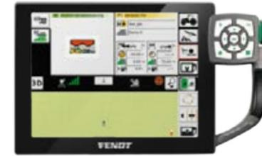
VarioDoc обеспечивает беспроводную передачу данных с терминала Varioterminal в полевую базу данных. VarioDoc Pro постоянно регистрирует положение и параметры машины, а передавать данные можно по мобильной сети.
