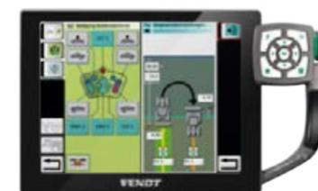
Функции управления навесным ISOBUS-оборудованием и действиями на поворотной полосе могут быть назначены на многофункциональный рычаг. В сочетании с автоматической системой рулевого управления VarioGuide, Variotronic™ обеспечивает автоматическую активацию последовательностей операций на поворотной полосе.
