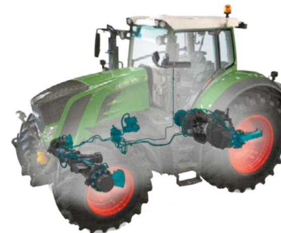
Встроенная система регулировки давления в шинах VarioGrip способна в кратчайшие сроки изменить давление в шинах от 0,6 до 2,5 бар - даже в процессе движения. Этого удалось достичь благодаря встроенному радиальному поворотному сквозному каналу подкачки на всех колесах, который рассчитан на весь срок службы трактора. Воздух поступает от двухступенчатого компрессора с водяным охлаждением и собственного клапанного оборудования машины.
