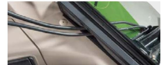
■ Fendt предлагает оригинальное решение для кабелей, идущих в кабину со стороны задней части трактора. Кабели любого сечения могут быть заведены через специальный ввод. Заднее окно можно закрыть, чтобы в кабину не попадала пыль, грязь, вода и шум.
