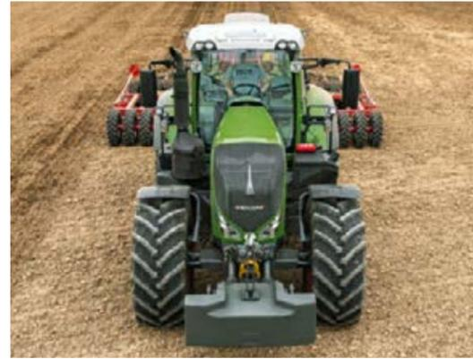
При создании Fendt 800 Varío особое внимание уделялось обеспечению оптимального обзора. Капот был выполнен как можно более узким, поэтому водителю прекрасно видны колесные арки и переднее навесное оборудование.
