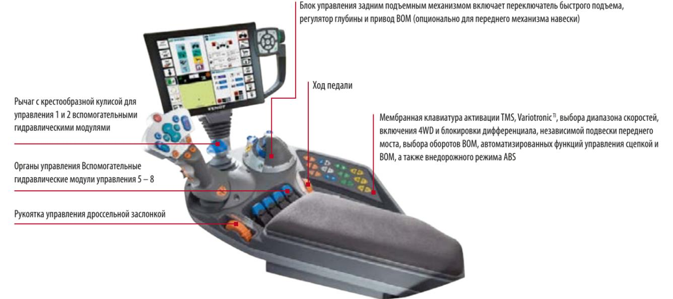
Рычаг с крестообразной кулисой для управления 1 и 2 вспомогательными гидравлическими модулями
