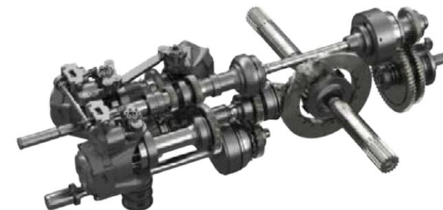
Коробка передач Fendt Vario – гидрообъемно-механическая, с делителем мощности. При повышении скорости увеличивается доля механической мощности, передаваемой через планетарную передачу. Гидростаты поворачиваются на 45 градусов и отличаются высокой максимальной рабочей мощностью (550 бар), что гарантирует исключительную эффективность.
