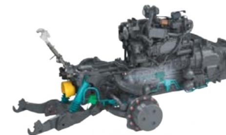
Удобный передний механизм навески Fendt 800 Vario оснащен опциональной системой разгрузки. Он позволяет перенести вес навесного оборудования на трактор при определенном давлении. Это очень удобно в зимнее время или при работе с фронтальной косилкой, поскольку вес переносится на передний мост и за счет этого повышается управляемость.
