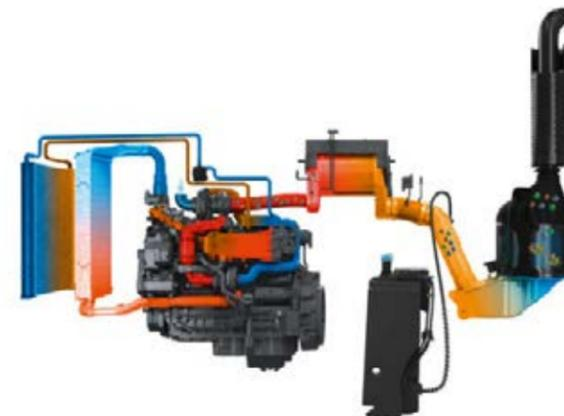
Реверсивный вентилятор может автоматически изменять направление воздушного потока – отныне в качестве последовательности действий при развороте на конце полосы – благодаря чему элементы охладителя эффективно очищаются. Что особенного? Положение лопастей вентилятора регулируется в зависимости от потребностей в охлаждении, тем самым повышая эффективность охлаждения. Это положительно сказывается на расходе топлива.
