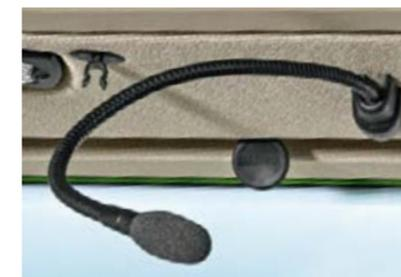
Высокое качество звука при телефонных переговорах без использования рук обеспечивается благодаря подвижному микрофону, установленному на гибком креплении.
