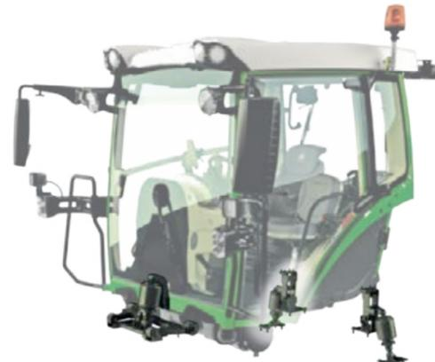
□ Подвеска кабины с пневмопружинами сводит к минимуму вибрацию кабины. Значительная разница по высоте и большое расстояние между пружинными элементами кабины X5 также предотвращает раскачивание и обеспечивает максимальный комфорт при движении.
