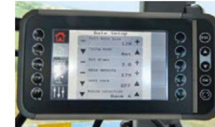
Благодаря интерфейсу ISOBUS пресс-подборщик беспрепятственно связывается с терминалами ISOBUS, интегрированными в трактор, включая Varioterminal от Fendt.
