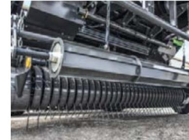
Благодаря малому зазору между подборщиком и ротором растительная масса транспортируется деликатно и надежно. Благодаря V-образной форме прессовальной камеры ее наполнение происходит равномерно, что в свою очередь позволяет получать безупречные рулоны.
