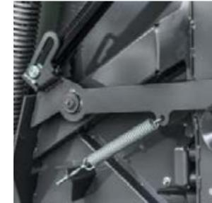
Телескопическая раampa для рулонов, которую можно регулировать без использования инструментов, обеспечивает рулону нужный импульс и предотвращает столкновение задней стенки с рампой.
