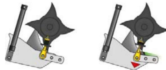
Система сброса нагрузки FlexControl надежно предотвращает забивания.
