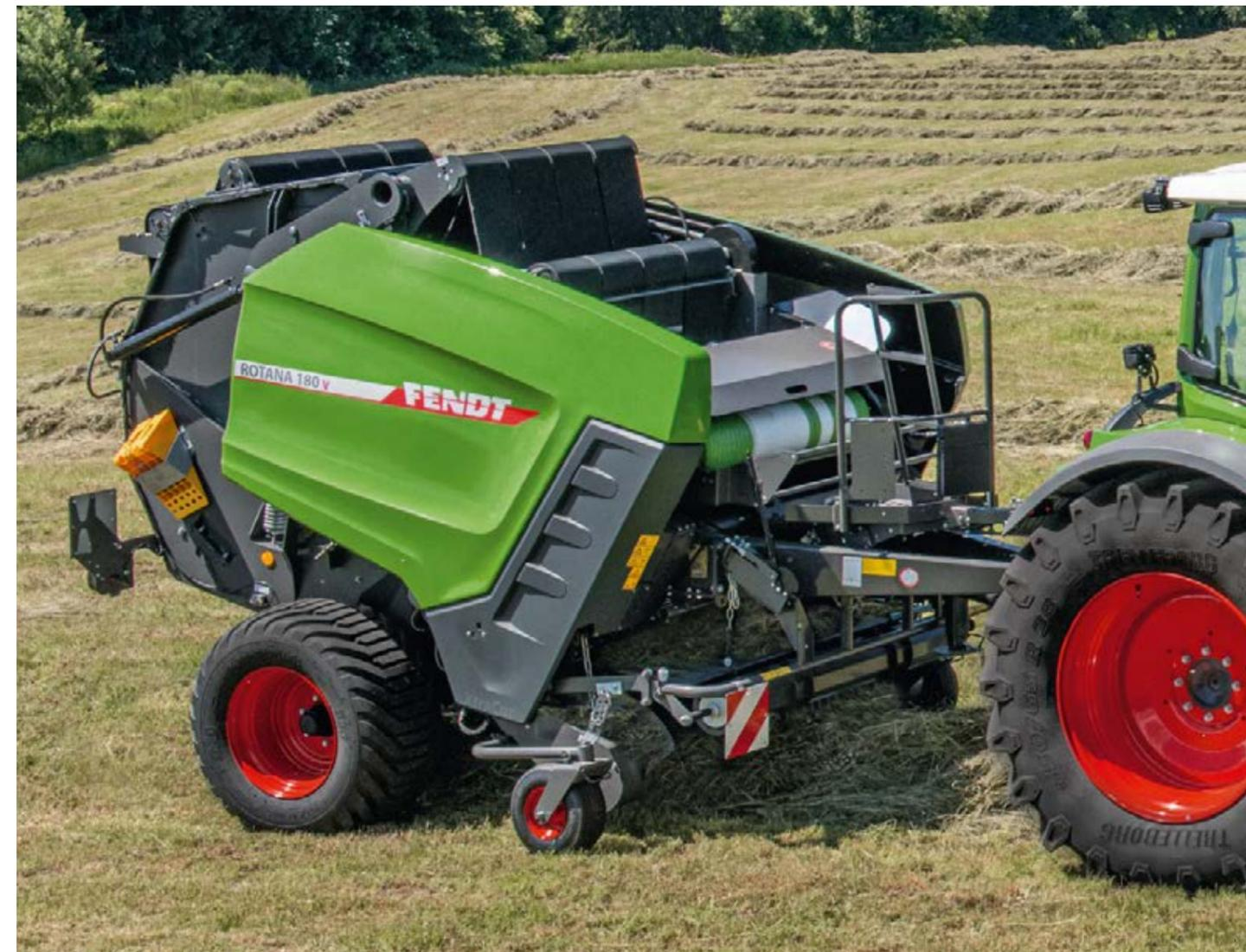
Бескулачковый подборщик работает плавно и не требует чрезмерных усилий при обслуживании. Копирующие колеса могут быть неподвижными или поворотными в зависимости от конфигурации.
