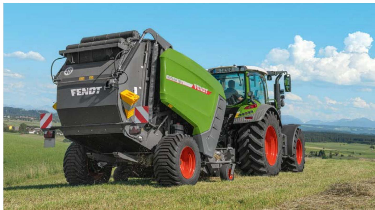
Благодаря большим шинам рулонные пресс-подборщики Fendt с прессовальной камерой переменного объема сохраняют высокую проходимость на любых поверхностях и не вредят почве при передвижении.
