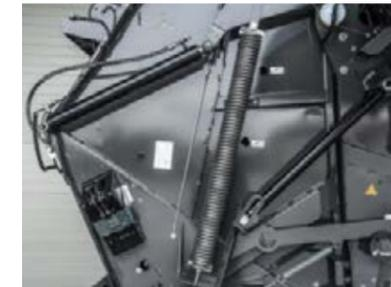
Благодаря умной подвеске заднего борта с качающимся рычагом борт опускается по мере увеличения рулона.
