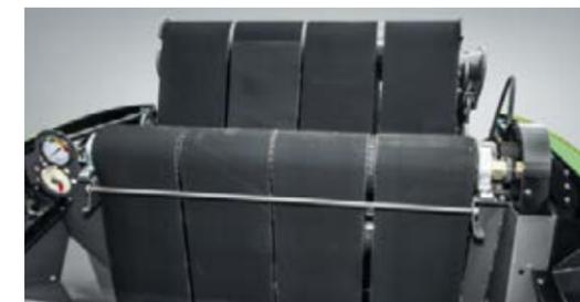
Четыре симметрично расположенных бесшовных ремня формируют рулоны. Привод задействуется двумя приводными вальцами, которые передают именно то усилие, которое необходимо.
