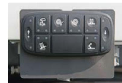
Управление комбинаций пресс-подборщика и обмотчика является действительно простым благодаря панели, устанавливаемой в задней части техники для обеспечения ручного управления.
