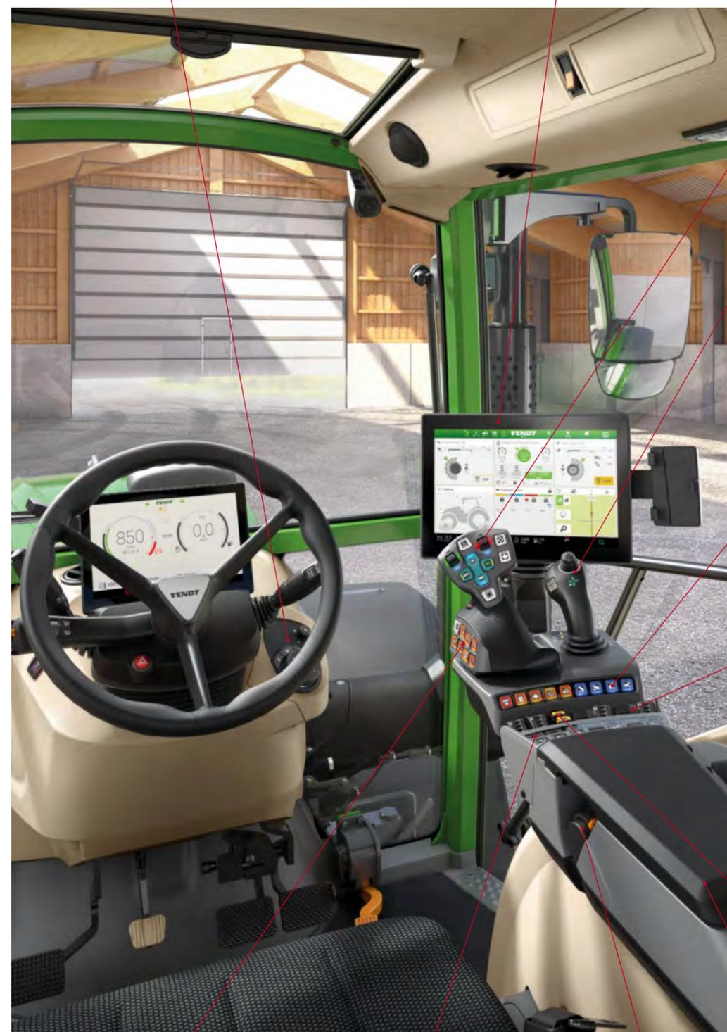
Новый многофункциональный джойстик включает в себя не только знакомую перекрестную схему работы, но и два элемента управления пропорциональными клапанами, а также четыре свободно назначаемых белых кнопки.
