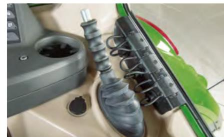
Fendt предлагает оригинальное решение для кабелей, идущих в кабину со стороны задней части трактора. Кабели можно пропустить через специальный ввод, независимо от их сечения. Для предотвращения проникновения в кабину пыли, грязи или воды, а также для снижения уровня шума заднее окно может быть закрыто.
