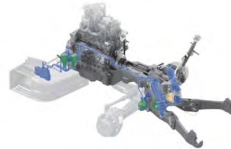
Передняя навеска полностью интегрирована и плотно прилегает к трактору. Это обеспечивает высокую маневренность трактора в связке с агрегатами. Нижние тяги имеют низкорасположенную точку крепления и могут быть сложены в положение хранения. Сильфоны защищают подъемные цилиндры от ударов камней. Система демпфирования вибраций, устанавливаемая в стандартной комплектации, предотвращает раскачивание оборудования и гарантирует безопасное движение и комфорт.
