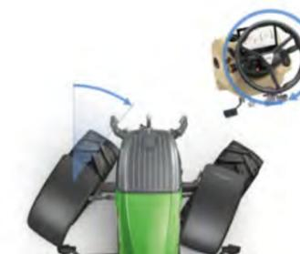
На разворотной полосе или во время фронтальных погрузочных работ вы можете воспользоваться системой рулевого управления FendtActive\*, которая обеспечивает полный поворот колес всего за один оборот руля. До 8 км/ч активная система рулевого управления работает без ограничений, от 8 до 18 км/ч ее эффект работы является линейным.
