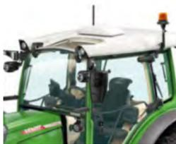
Приемник Fendt Guide превосходно защищен и полностью интегрирован в конструкцию крыши. Это устройство не имеет выступающих частей и проводов с внешним подключением и поэтому всегда хорошо защищено не только от свисающих ветвей, но даже от кражи.
