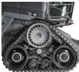
Гусеничное шасси TrakRide минимизирует давление на грунт.
