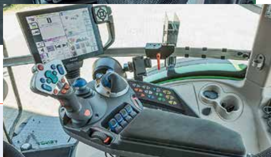
Приборная панель заменяет дисплей угловой стойки. Рычаг ручного тормоза расположен далеко впереди, но, к счастью, используется не слишком часто благодаря отличной парковочной блокировке трактора
