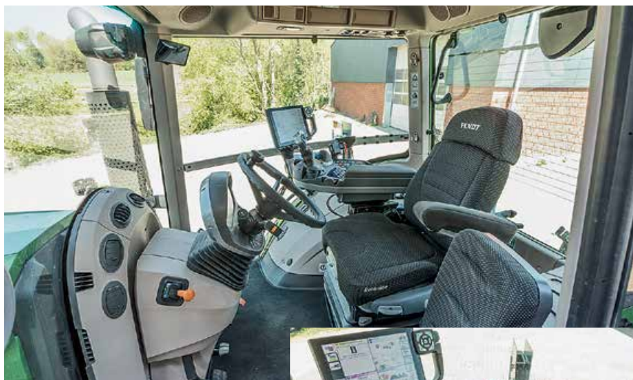
Кабина у 900-й серии один в один, как у 1000-й. А вот ее подвеска опирается не на четыре, а на три точки
