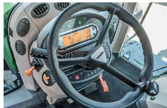
Приборная панель заменяет дисплей угловой стойки. Рычаг ручного тормоза расположен далеко впереди, но, к счастью, используется не слишком часто благодаря отличной парковочной блокировке трактора
