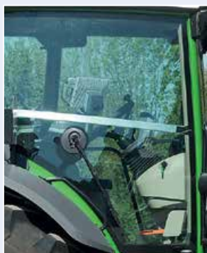
Стеклоочиститель для очистки бокового стекла
