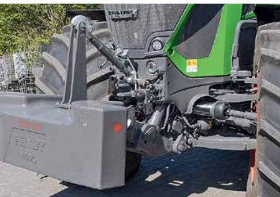
Передний мост обеспечивает постоянный полный привод вплоть до 25 км/ч
