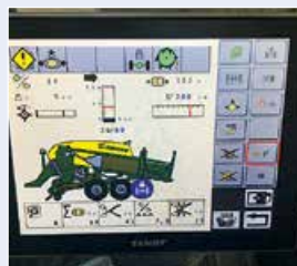
Отображение в терминале машин, совместимых с протоколом ISOBUS, оказалось нечетким
