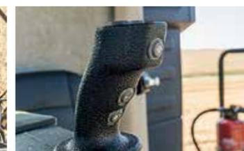
На джойстике находятся кнопки включения повторителей поворотов, а на его передней стороне — прибор освещения, функции автоматического рулевого управления и звукового сигнала
