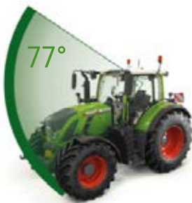
Den välvda vindrutan på VisioPlus-hyten ger en betraktningvinkel på 77°.
