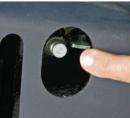
□ Trycket för förspänning av larvbanden kan enkelt ställas in från sidan med hjälp av en anslutning.
